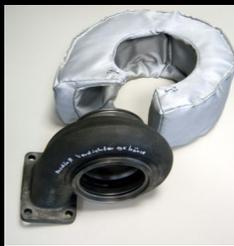
Vielfach sieht man auch **Glasgewebeband** als Not-Isolierung. Dies ist, wie der Name schon sagt, nur eine Notlösung zum Berührungsschutz. Der Wärmestrom geht durch das lockere Gewebe hindurch und heizt die Umgebung trotzdem auf. (Im Handel sind diese Produkte bekannt unter **Hitzeschutzband** oder **Hitzeschutzbänder**.) Hier sollte man schnell für Ersatz sorgen. Auch die **Reparatur der Abgasrohr Isolierung mit Isoliermatratzen** ist möglich.
